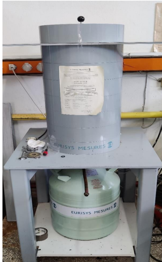
Εικόνα 3.7: Ανιχνευτής HPGe στο εργαστήριο Πυρηνικής Τεχνολογίας του Α.Π.Θ
