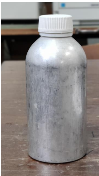
Εικόνα 3.1: Αλουμινένιο δοχείο για την μεταφορά δείγματος νερού
