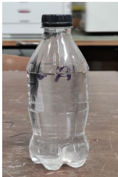
Εικόνα 3.2: Πλαστικό δοχείο τύπου PET για την μεταφορά δείγματος νερού
