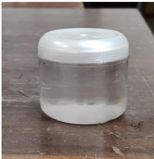
Εικόνα 3.3: Δείγμα νερού τοποθετημένο σε πλαστικό δοχείο για μέτρηση στον ανιχνευτή HPGe
