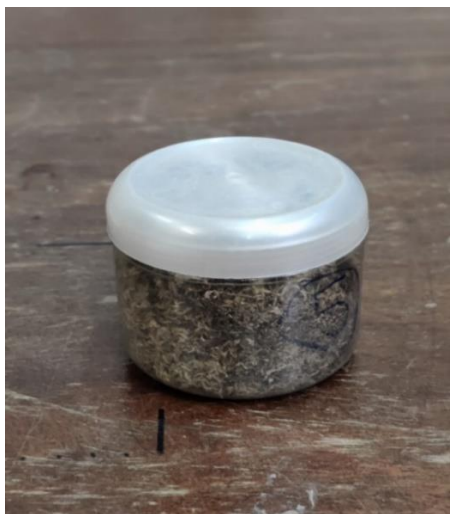
Εικόνα 3.6: Δείγμα βρύων τοποθετημένα σε βαθμονομημένο πλαστικό δοχείο για μέτρηση στον ανιχνευτή HPGe
