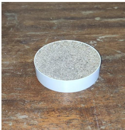
Εικόνα 3.5: Δείγμα χώματος τοποθετημένο σε πλαστικό δοχείο pbq1 για μέτρηση στον ανιχνευτή HPGe
