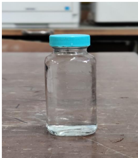
Εικόνα 3.4: Δείγμα νερού τοποθετημένο σε γυάλινο δοχείο για μέτρηση στον ανιχνευτή EIC
