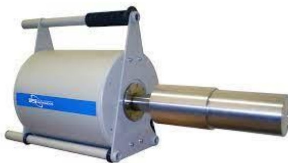
Εικόνα 4 : Φορητός Ανιχνευτής HPGe. Διακρίνεται Αριστερά το Δοχείο Υγρού Αζώτου.
