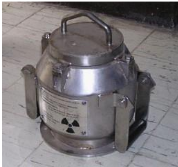
Εικόνα 15 : Συσκευή Μεταφοράς Ραδιενεργών Πηγών Ακτινοβολίας Βήτα και Γάμμα
